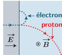
Dans un cadre plus général, la trajectoire possible pour une particule chargée soumise à un champ magnétique sera une hélice "s'enroulant" autour du champ, combinant le mouvement de rotation à un mouvement de translation. C'est le cas lorsque la vitesse n'est pas initialement perpendiculaire au champ magnétique, et où la vitesse selon l'axe du champ magnétique n'est pas modifiée par la force.
