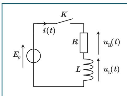
Figure 6.7 – Circuit composé d'une inductance en série avec une résistance, couramment appelé circuit RL
