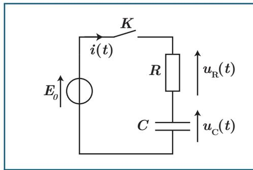
Figure 6.2 – Schéma d'un circuit appelé "circuit RC"
