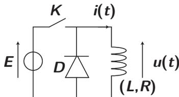
On considère le montage ci-contre. On donne  $E = 12V$ ,  $L = 15 \text{ mH}$ ,  $R = 100 \Omega$ . Le dipôle  $D$  est une diode idéale, composant ne laissant passer le courant que dans le sens de la flèche (avec alors une tension nulle à ses bornes). À la date  $t = 0$  on ferme l'interrupteur.
