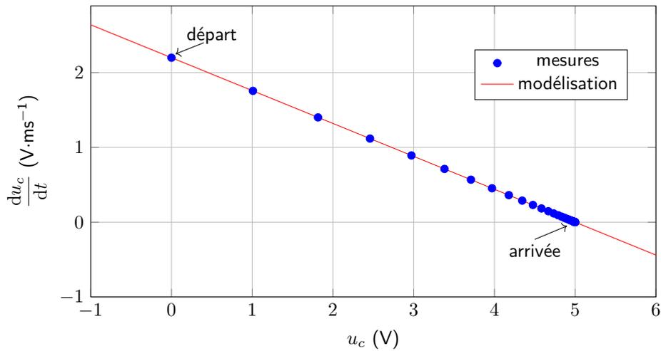
**Figure 6.6** – Portrait de phase lors de la charge d'un circuit RC : superposition des mesures expérimentales et de la courbe théorique.
