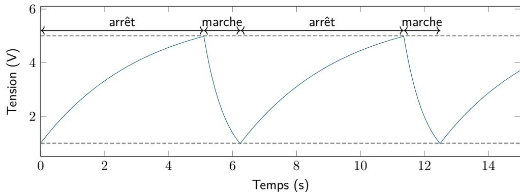
Figure 6.1 – Signal de commande du relais actionnant un essuie-glace
