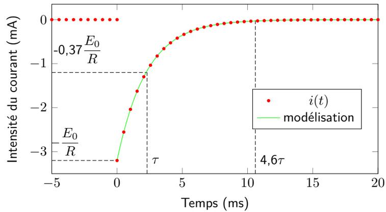
Figure 6.5 – Évolution du courant lors de l'évolution libre d'un circuit RC
