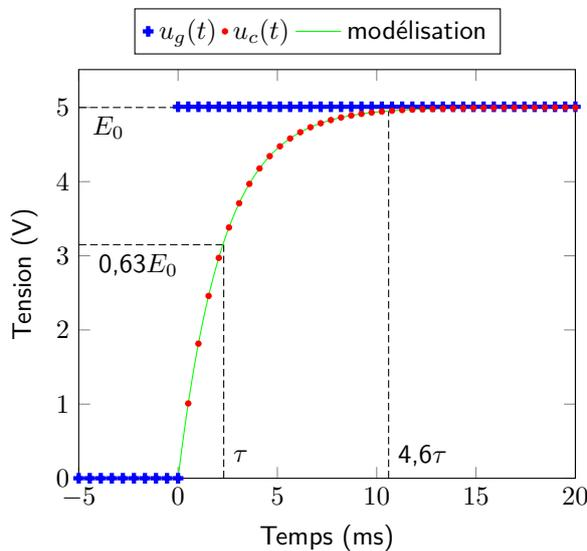
**Figure 6.3** – Tension  $u_c$  lors de la charge d'un condensateur pour un circuit RC et modélisation théorique.
