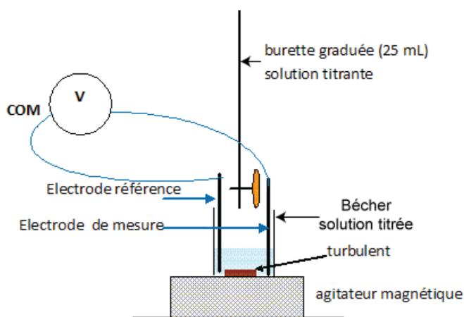
L'électrode permettant d'avoir accès au potentiel de la solution est très souvent d'une électrode de platine. L'autre électrode doit conserver un potentiel constant au cours du dosage : on utilise souvent une électrode au calomel saturé (électrode de référence courante et peu onéreuse). On mesure alors une tension  $U = V_{sol} - V_{ref}$  à l'aide d'un voltmètre.
