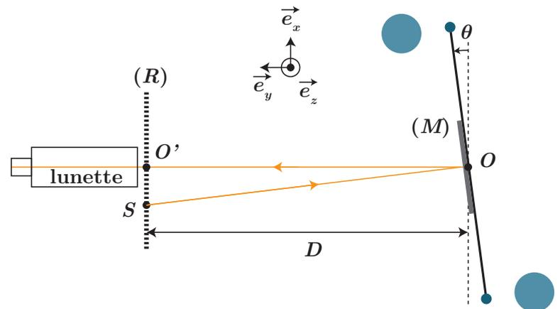
4. La lunette de visée comporte deux lentilles convergentes, l'objectif étant positionné approximativement en  $O'$  et ayant une distance focale image de  $f'_1 = 30 \text{ cm}$ . On définit la puissance de la lunette comme  $P = \frac{\alpha'}{AB}$  où  $\alpha'$  est l'angle sous lequel on voit un objet  $AB$  au travers de la lunette de visée. Déterminer la distance focale de l'oculaire et l'encombrement de la lunette si on veut que  $P = 10 \delta$ .
