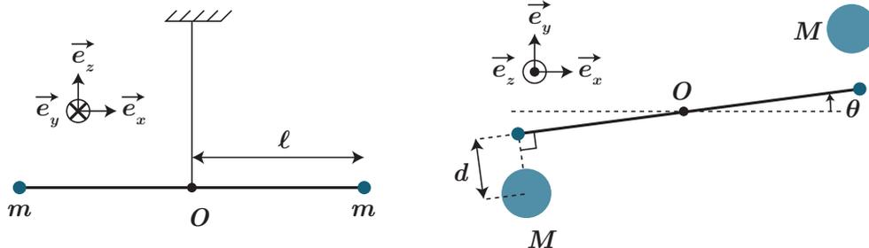
Dans la suite, on note  $\theta$  la déviation angulaire du pendule par rapport à sa position d'équilibre. On note  $k$  la raideur angulaire du fil de torsion : le moment du couple de rappel est  $-k\theta\vec{e}_z$ . Les sphères de masse  $M$  et les particules de masse  $m$  sont considérées comme des particules ponctuelles. Le moment d'inertie de la tige et des deux masses  $m$  par rapport à l'axe du fil de torsion s'exprime de manière approchée par  $J = 2m\ell^2$ .
