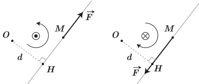
Exemple de l'ouverture de la porte : la poignée est placée de manière à être la plus éloignée de l'axe de rotation, afin que le bras de levier soit le plus important, et donc le moment est plus important, à force d'intensité égale.
