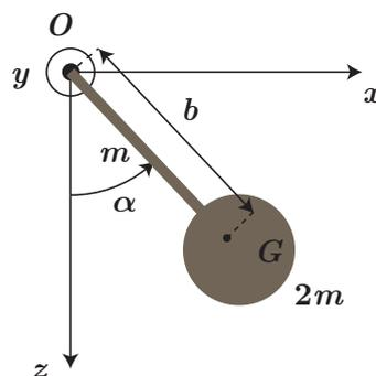
On écarte le pendule d'un angle  $\alpha_0$  par rapport à sa position d'équilibre, et on le lâche sans vitesse initiale à la date  $t = 0$ . On étudie son mouvement ultérieur en observant l'angle  $\alpha$  que forme la direction de la barre avec l'axe vertical descendant  $(Ox)$ .
