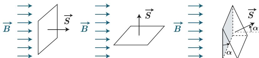
\* Qu'en est-il dans un cas intermédiaire ? Dans le cas où existe un angle entre  $\vec{B}$  et  $\vec{S}$ , la surface équivalente traversée par le champ magnétique vaut  $S \cos \alpha$ , et le flux vaut alors  $\Phi = BS \cos \alpha$ .
