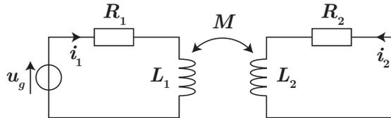
Pour la bobine 1,  $\Phi_1 = L_1 i_1 + M i_2$  et pour la bobine 2  $\Phi_2 = L_2 i_2 + M i_1$  conduisant aux équations différentielles suivantes par l'application de la loi des mailles :
