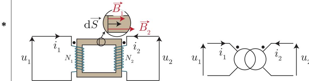
Les bornes homologues sont également précisées sur le symbole du transformateur, permettant de préciser les orientations sans avoir à dessiner le bobinage.
