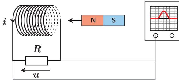
\* Ceci nous permet de conclure qu'il y a apparition d'un courant dans un circuit fermé alors même qu'il n'y a aucun générateur. On met ici en évidence un phénomène d'**induction électromagnétique** : la **variation de champ magnétique** traversant le circuit est la cause d'un courant appelé **courant induit** dans un circuit fermé, mais également d'une tension appelée **fém induite** aux bornes d'un circuit ouvert.
