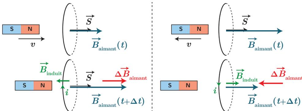
À l'inverse, lorsque l'aimant s'éloigne de la spire, et donc que le flux de son champ magnétique diminue, le courant induit est de sens opposé et le champ magnétique induit tend à compenser également la diminution de champ magnétique.
