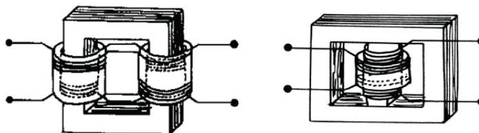
L'intérêt d'utiliser un circuit magnétique est qu'il canalise le flux magnétique, illustré ci-dessous, avec une bobine seule à gauche, et à droite avec un ferromagnétique));
